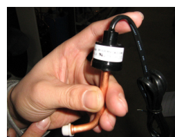
Figura 28: Pressostato di minima.
